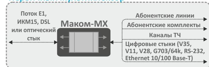
В режиме оконечного мультиплексора аппаратура позволяет подключать устройства через аналоговые и цифровые стыки и осуществлять соединение судалярными устройствами по потокам E1, ИКМ15 или по оптическому кабелю по технологии TDMoP.
