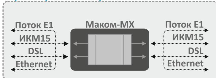
Аппаратура выполняет функции кросской коммутации – электронного кроссирования информации 64 кбит/с и п x 64 кбит/с, которая содержится в канальных интервалах входящих сигналов 2048 кбит/с и 1024 кбит/с, на позиции любых исходящих канальных интервалов исходящих сигналов 2048 кбит/с и 1024 кбит/с. Максимальное число формируемых аппаратурой цифровых потоков E1 – 32.
